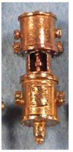
30193 Bremszylinder mittlere Größe für Lokomotiven und Tender
