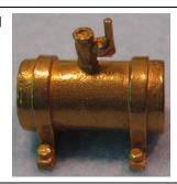
30152 Kreuzkopf-Wasserpumpe mit Hebelgestänge und Injektor (Einspritzventil)
