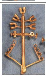
30138 Dampfverteiler – Dampfentnahmestutzen auf dem Stehkesselsattel mit 6 Ventilabgängen
